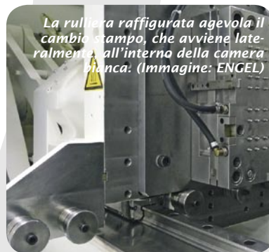
Per produrre i componenti in materiale termoplastico delle valvole per il settore farmaceutico, V.A.R.I. impiega presse a iniezione ENGEL completamente elettriche. La camera bianca è a norme ISO 8, mentre l'unità a flusso laminare garantisce il rispetto delle norme ISO 7 all'interno del gruppo di chiusura. (Immagine: ENGEL)
