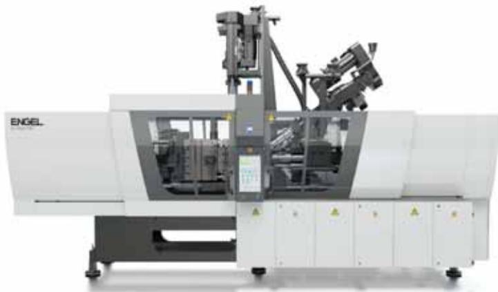
nuovo, ricorrendo a una tecnologia di rotazione dei maschi basata su due alberi rotanti; i due componenti stampati vengono estratti dallo stampo, ruotati di 180° e infine inseriti nuovamente nello stampo per il sovrastampaggio dell'anello di chiusura.
