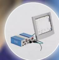
CoMo Injection, il nuovo sistema di controllo realizzato da Kistler, è in grado di analizzare la pressione in cavità stampo durante il processo di iniezione e valutare automaticamente la qualità del pezzo prodotto. CoMo Injection è in grado di gestire contemporaneamente i segnali provenienti da sedici cavità sullo stesso stampo, la sua configurazione è sem-
