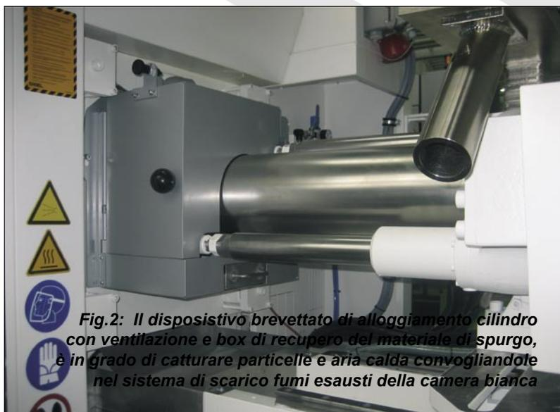
*Fig.2: Il dispositivo brevettato di alloggiamento cilindro con ventilazione e box di recupero del materiale di spurgo, è in grado di catturare particelle e aria calda convogliandole nel sistema di scarico fumi esausti della camera bianca*
