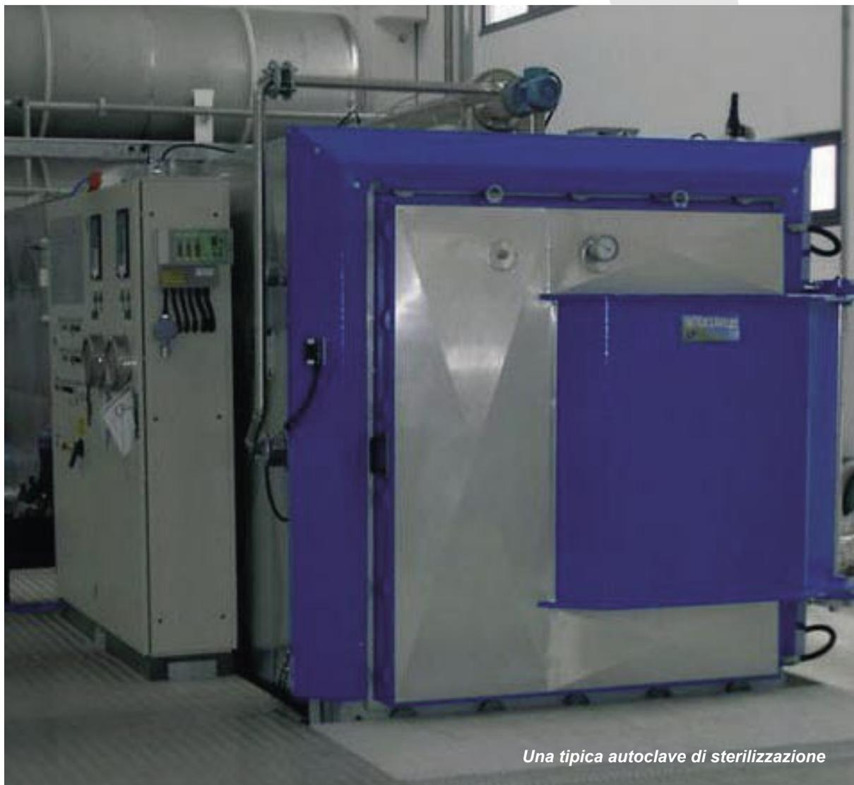
*Una tipica autoclave di sterilizzazione*
